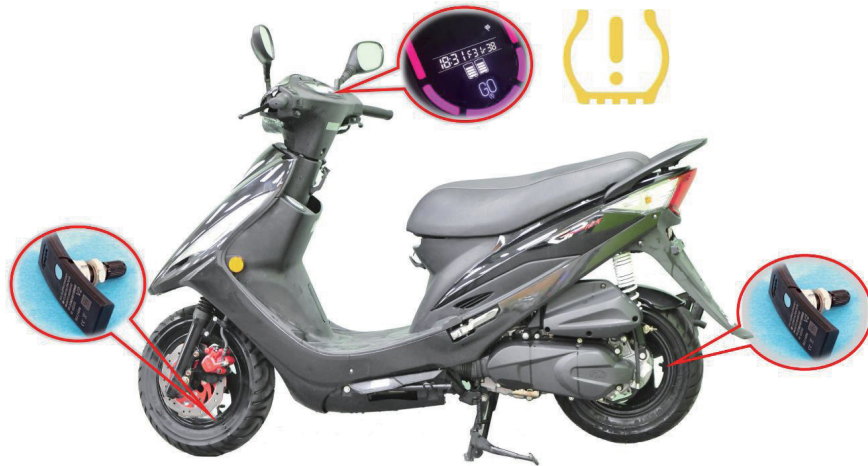
圖 3-19 一般機車的輪胎壓力偵測系統（TPMS）相關裝置位置示意圖
