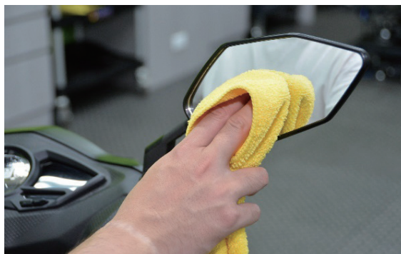
圖 2-20 用布清潔照後鏡鏡面
