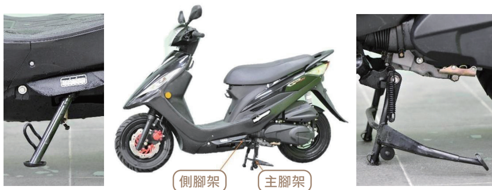
圖 3-10 機車駐車腳架裝置位置
