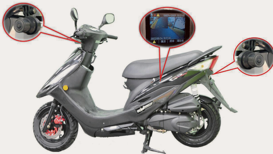
圖 3-16 常見機車行車影像記錄器主要組件裝置位置
