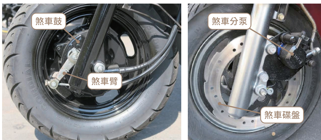
圖 3-8 機車前輪煞車機構，鼓式煞車（左圖）及碟式煞車（右圖）
