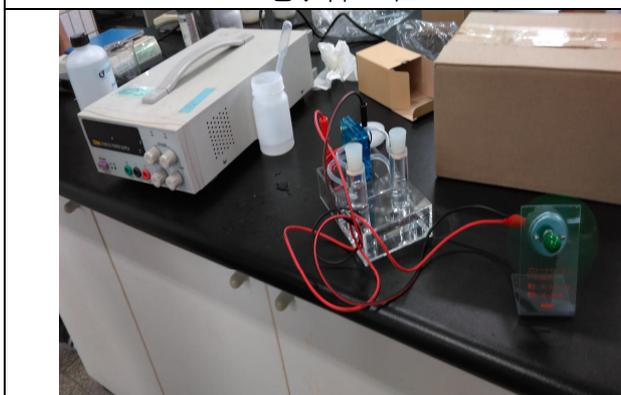
水電解和燃料電池兩用型實驗器
