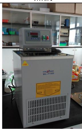
低溫冷卻循環水槽
